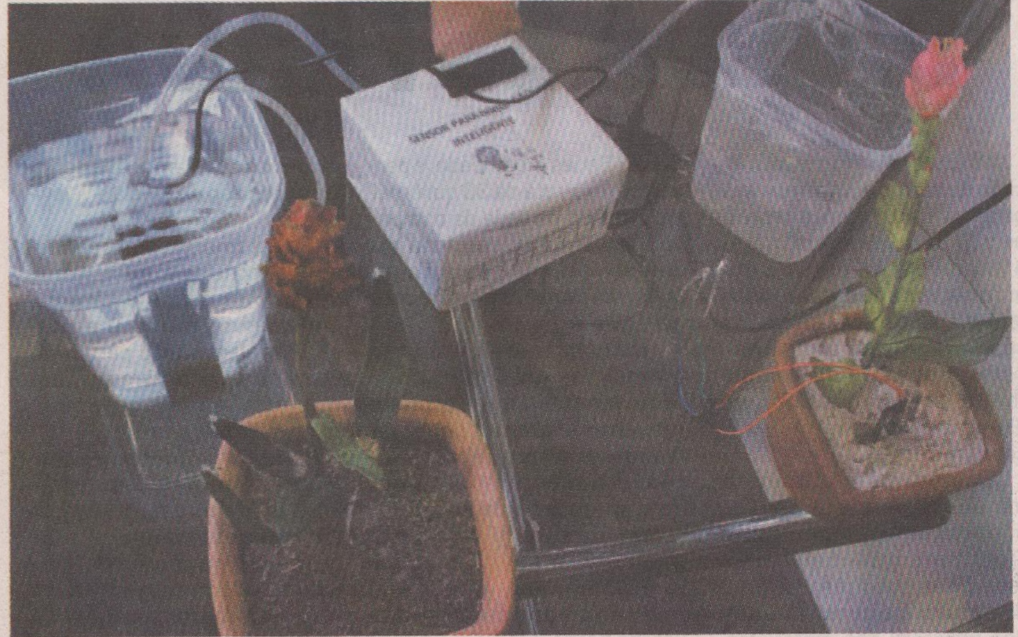
Sensor lê umidade do solo e inicia processo de irrigação automaticamente quando necessário
